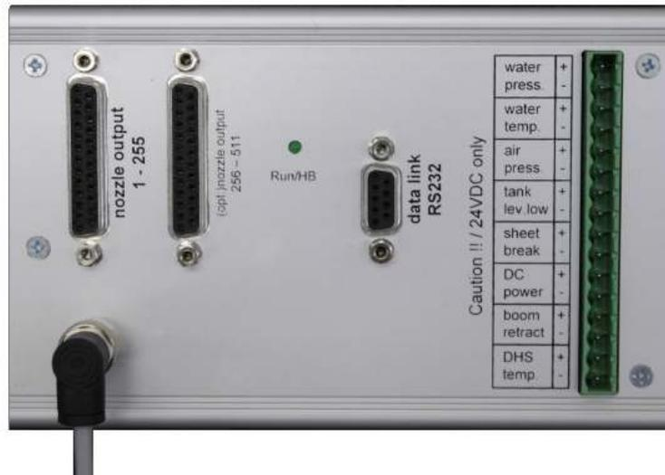
Ein multifunktionales Interface zur Steuerung von Befeuchtungsanlagen.
